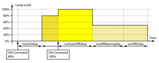
Figure 138: Timing Parameters (*nciAutoOffRestart*=ST\_ON)
