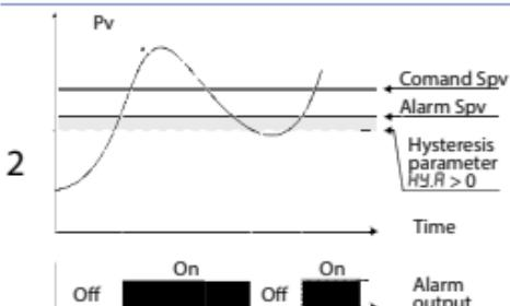
Allarme di deviazione superiore con valore di setpoint allarme minore di "0".
