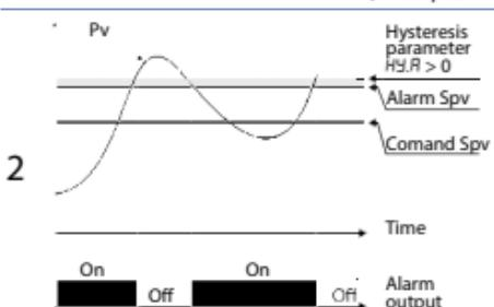
Allarme di deviazione inferiore con valore di setpoint allarme minore di "0".
