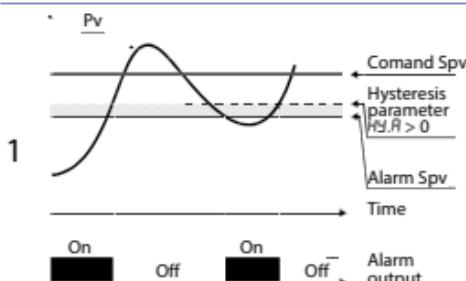
Allarme di deviazione inferiore con valore di setpoint allarme maggiore di "0".
