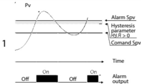
Allarme di deviazione superiore con valore di setpoint allarme maggiore di "0".
