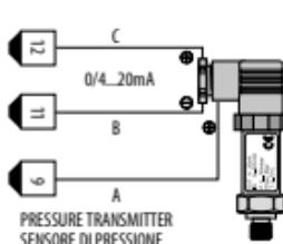
Per segnali normalizzati in corrente 0/4..20mA **con sensore a tre fili**
