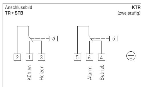
**THERMASREG® KTR – Kanaltemperaturregler, einstufig**
