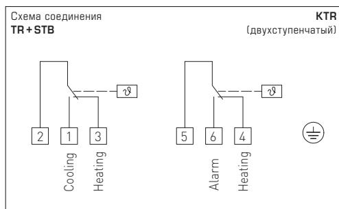
**THERMASREG® KTR** – Терморегулятор канальный, одноступенчатый
