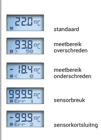
Display en zelfdiagnose RPTM-1 met display
