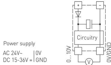
Если для питания нескольких приборов используется напряжение 24 В **переменного тока**, необходимо следить за тем, чтобы все положительные входы рабочего напряжения (+) полевых устройств были соединены друг с другом. Это относится также ко всем отрицательным входам рабочего напряжения (-) = опорного потенциала (синфазное подключение полевых устройств). Все выходы полевых устройств должны относиться к одному потенциалу!
