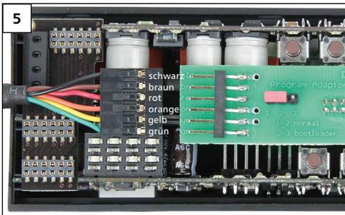
Flachstecker des Adapter-Kabels auf die Stiftleiste aufstecken.
