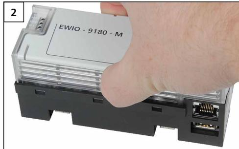
Gehäusedeckel durch seitliches eindrücken lösen...
