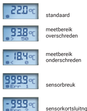
Display en zelfdiagnose ALTM2 met display
