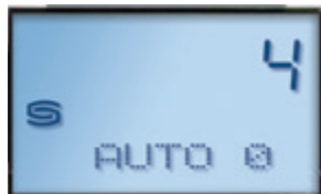
nulpunktkalibrering actief kalibratietijd in seconden
