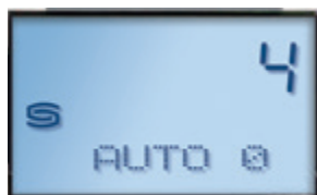
nulpunktkalibrering actief kalibratietijd in seconden
